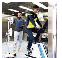
▲呼吸ガス分析器による有酸素性能力の測定中。
