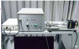
独自開発したナノ構造間相互作用精密制御装置 (PICSN)
