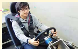
操作意図を検出するステアリングシステム
