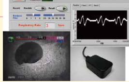
冬眠中のクマの非接触バイタルサインモニタシステム
