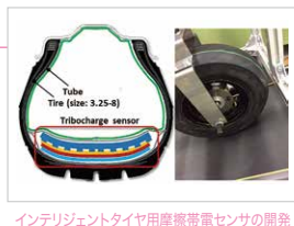
インテリジェントタイヤ用摩擦帯電センサの開発
