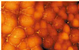
超音波AFMによるPZT圧電セラミック境界欠陥電荷イメージ
