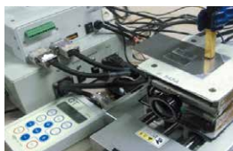
ケルビン法による金属表面の電位の測定
