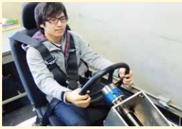
操作意図を検出するステアリングシステム
