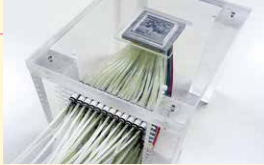
ファントムセンセーションを用いた空気噴流による非接触型触覚ディスプレイ
