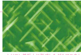
シリコン基板上に形成したゲルマニウムナノワイヤ配列
