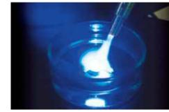
光照射による骨類似物質の急速成膜
