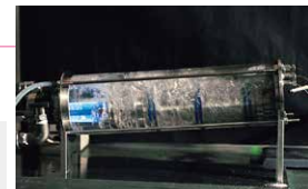
渦流燃焼器を用いた過熱蒸気発生器
