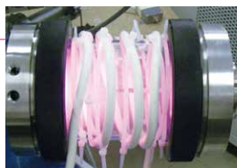
プラズマ中性子源のイオン源の放電の様子
