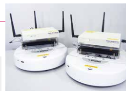
群ロボットネットワーク用実験プラットフォーム
