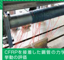
CFRPを接着した鋼管の力学 挙動の評価
