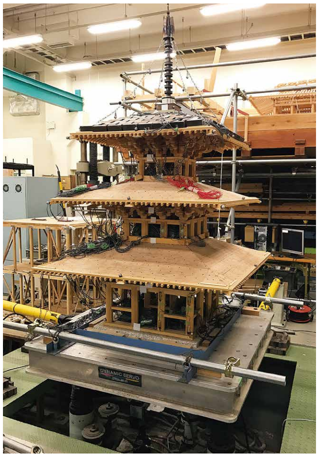
三重塔の構造実験の様子
