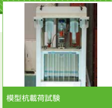
模型杭載荷試験
