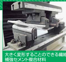
大きく変形することのできる繊維 補強セメント複合材料
