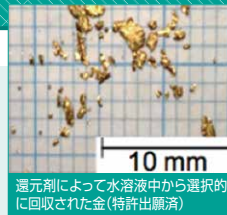
還元剤によって水溶液中から選択的に回収された金（特許出願済）
