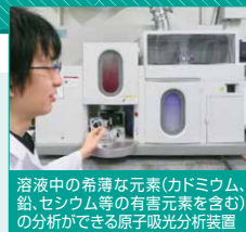
溶液中の希薄な元素（カドミウム、鉛、セレンウム等の有害元素を含む）の分析ができる原子吸光分析装置
