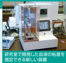
研究室で開発した血液の粘度を測定できる新しい装置
