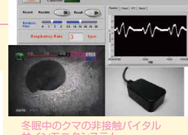
※服中のクマの非接触バイタルサインモニタリングシステム
