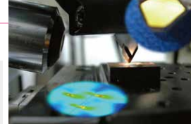
超微細加工機上での超精密切削の様子
