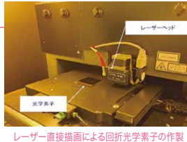
レーザー直接描画による回折光学素子の作製
